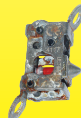
经240小时20%的盐雾测试后镀锌钢的火警探测机械装置
